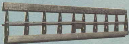
Fig. 1 - Prima fase di costruzione dell'ala: le centine, allineate sul piano di montaggio, vengono unite ai bordi di entrata e di uscita, nonché ai longeroni. Numerosi spilli, opportunamente disposti, mantengono le parti ben ferme.
